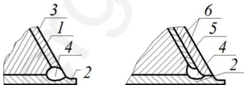
Рисунок 2 – Схема выполнения предварительной наплавки кромок деталей из двухслойных сталей с плакирующим слоем, не содержащим ниобий
