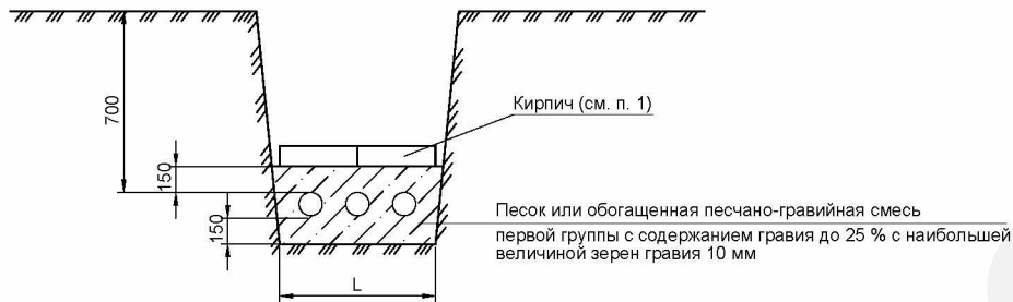
Рисунок 4 – Защита кабелей в траншее
