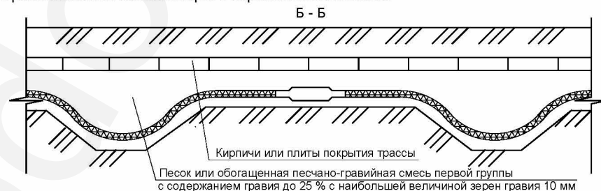
Вариант 3. Установка соединительной муфты для кабелей на наклонном участке (свыше 20°)
