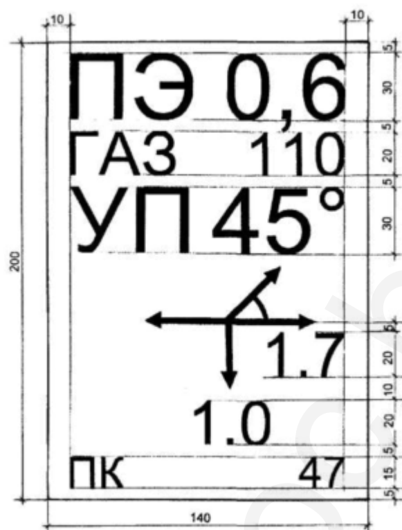
Рисунок 3. Полиэтиленовый газопровод, диаметр – 110 мм, угол поворота – 45°.
