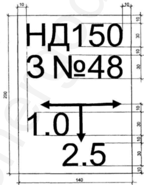
Рисунок 2. Газопровод низкого давления, диаметр – 150 мм, задвижка – № 48.
