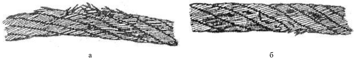
Рисунок 3. Обрывы проволок в зоне уравнительного блока: а – в нескольких прядях каната; б – в двух прядях в сочетании с местным износом
