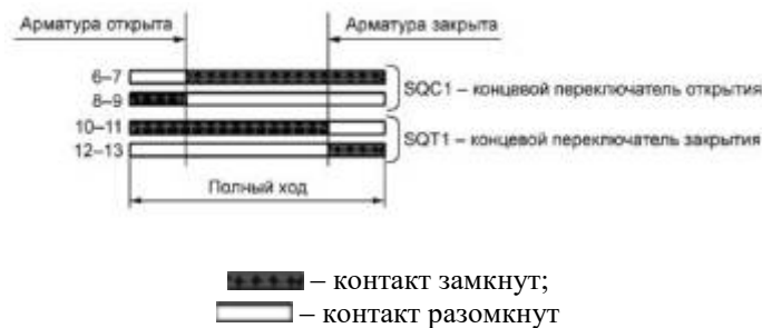
Рисунок 20.3. Электрическая схема соединения электромагнитов управления и концевых переключателей отсечной пневмоприводной быстродействующей арматуры (нормально открытая и нормально закрытая) при установке под оболочкой и вне оболочки 18
