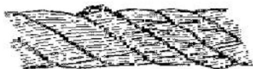
Рисунок 1. Обрывы и смещения проволок каната крестовой свивки
