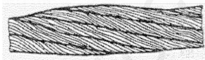
Рисунок 13. Местное увеличение диаметра каната
