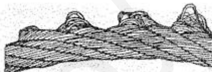
Рисунок 12. Выдавливание проволок прядей: а – в одной пряди; б – в нескольких
