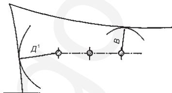
Рисунок 6.2.8 – Наименьшие расстояния между токоведущими частями разных цепей, расположенными в различных плоскостях с обслуживанием нижней цепи при неотключенной верхней
