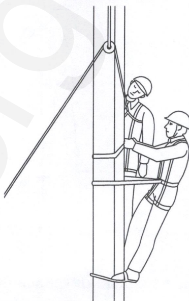
Рис. 9. Освобождение пострадавшего от фала монтерского пояса и когтей, когда он находится ниже проводов ВЛ
