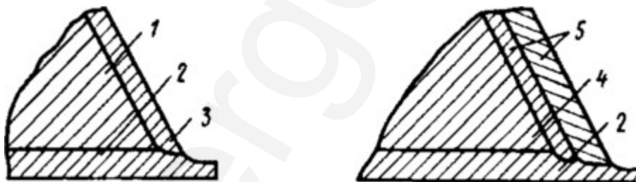
Рисунок 2. Схема выполнения предварительной наплавки крайков деталей из двухслойных сталей с плакирующим слоем, не содержащим ниобий: 1 – углеродистая или кремнемарганцовистая сталь; 2 – плакирующий слой; 3 – однородная наплавка; 4 – легированная сталь; 5 – двойная наплавка
