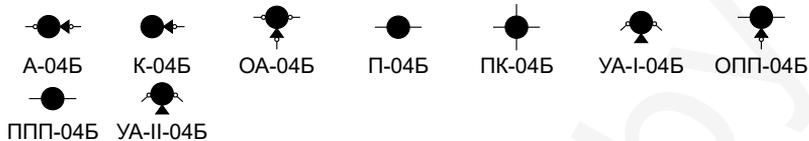
**Опоры с изолированными проводами на стойках СВ 95-2-в для одной цепи**
