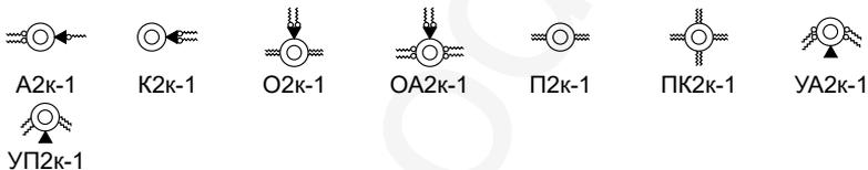
**Опоры повышенные с изолированными проводами на стойках СВ 110-1-а**
